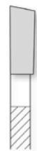
Zahn einseitig spitz, einseitig plan Tooth pointed on one side Ground flat on one side
