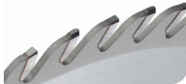
Hierfür nutzen wir unsere induktiven Lötssysteme für eine hochwertige Schneidstoffbestückung mit neuen Zähnen. Nachdem der Grundkörper plan läuft und die Bestückung vollständig ist, wird Ihr Sägeblatt nachgeschärft.
