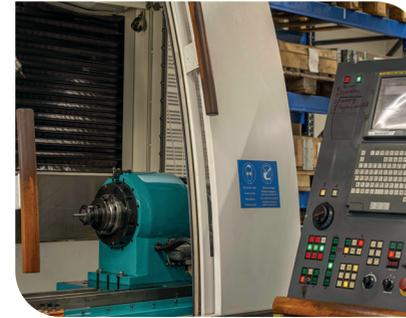
Hartmetallwerkzeuge aus Vollhartmetall können mehrmals nachgeschliffen werden und sorgen damit für eine optimale Kosteneffizienz. Mit unseren 5-Achs Schleifmaschinen schleifen wir alle Vollhartmetall- oder Hartmetallbestückten Werkzeuge nach.
