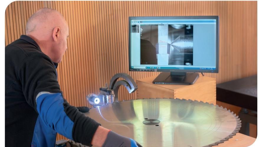
Nach dem erfolgten Flankenschliff muss die Abstumpfungsfase der Kreissägeblätter auf den CNC-Schleifmaschinen für den Brust- und Rückenschliff ausgeschliffen werden.
