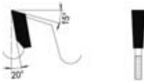
Flachzahn Flat tooth
