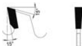
Flachzahn Flat tooth
