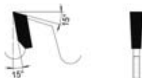
Flachzahn Flat tooth
