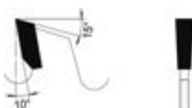
Flachzahn Flat tooth
