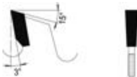
Flachzahn Flat tooth
