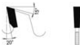
Flachzahn Flat tooth
