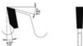
Flachzahn Flat tooth
