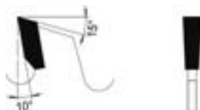
Flachzahn Flat tooth
