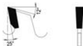
Flachzahn Flat tooth
