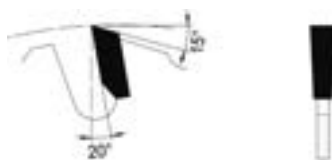
Flachzahn spandickenbegrenzt Flat tooth chip-thickness limited
