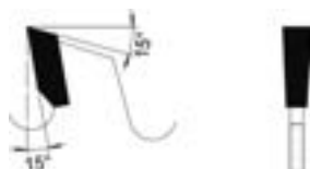
Flachzahn Flat tooth
