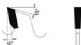
Flachzahn Flat tooth
