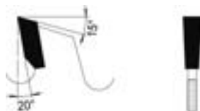
Flachzahn Flat tooth
