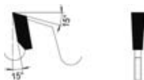
Flachzahn Flat tooth
