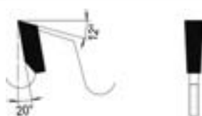
Flachzahn Flat tooth
