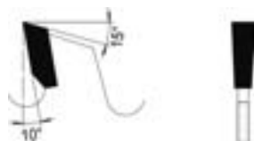
Flachzahn Flat tooth
