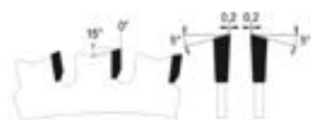
Wechselzahn mit Flachfase
