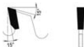
Flachzahn Flat tooth
