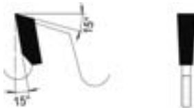
Flachzahn Flat tooth
