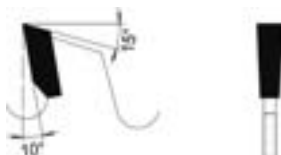
Flachzahn Flat tooth
