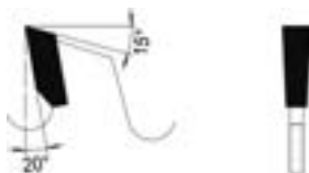
Flachzahn Flat tooth
