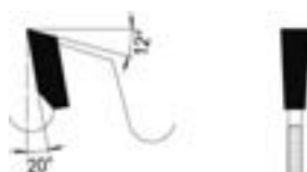
Flachzahn Flat tooth
