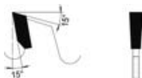
Flachzahn Flat tooth
