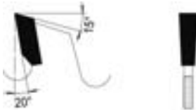
Flachzahn Flat tooth
