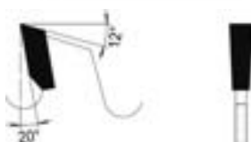
Flachzahn Flat tooth
