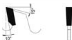
Flachzahn Flat tooth
