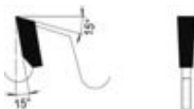
Flachzahn Flat tooth
