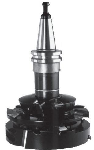
Oberes Blendrahmenholz IV78 Doppelfalzprofilierung upper window frame timber IV78 double rebate profiling
