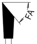
Fasenwinkel FA chamfer angle FA
