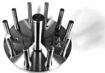
Einstelllehre zum Nachschärfen setting gauge for resharpening
