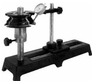
Messtisch mit Messuhr Table of geometric control with mechanical dial gauge
